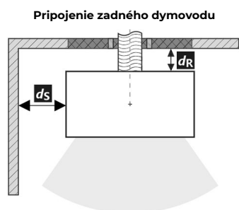
Pripojenie zadného dymovodu
