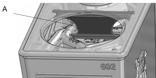
Fig. 27 Sostituzione del deflettore di scarico
