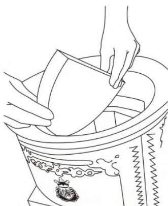
3. Odstráňte deflektor z ocele a diely na boku (F), predný dymový deflektor (E) a nakoniec zadný dymový deflektor (D).
