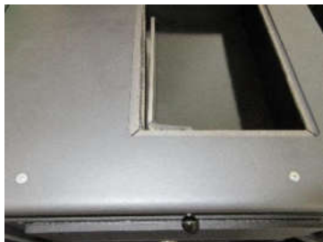
Obrázek 8b – Zátopová klapka zavřená – režim pečení v troubě a vaření na plotně.
