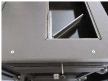
Obrázek 8a – Zátopová klapka otevřená – režim zatápění a intenzivního vaření po celé ploše plotny.
