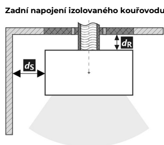
Zadní napojení izolovaného kouřovodu
